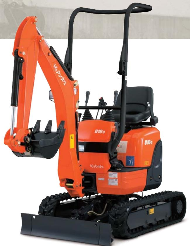
Der geringe Heckschwenkradius, die sehr kompakt und robuste Bauweise, sowie die einfache Bedienung. Der Kubota- Kurzheckbagger U10-3 vereint alle diese Merkmale, die Sie von einer anpassungsfähigen, effektiven und leistungsstarken Maschine erwarten.
